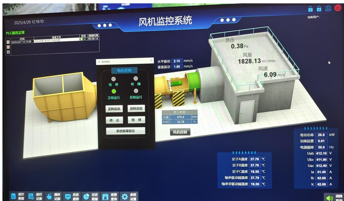
图2 通风机在线监测
